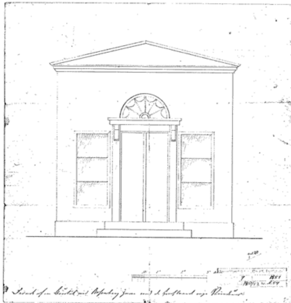
Fig. 9. Tegning fra 1852 af pavillon med forslag til nye vinduer på hver side af døren. Styrelsen for Slotte og Kulturrejendomme.
